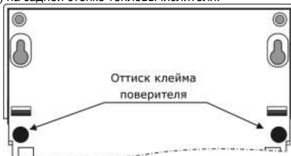
Рис. 1.2 – Места пломбирования поверителем
