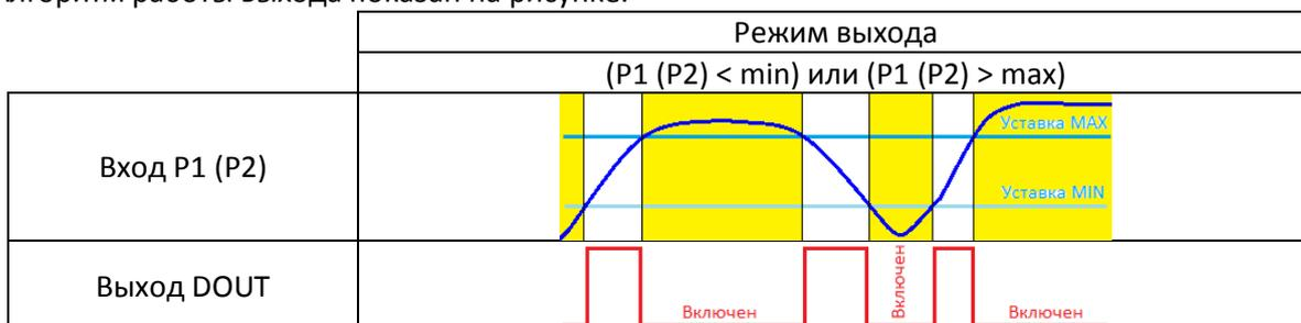
**Примечание** При установке признака «+Отсутствие измерений» в настройках дискретный выход переводится в состояние «Включен» при значении входного тока менее 3,2 мА или более 24 мА.
