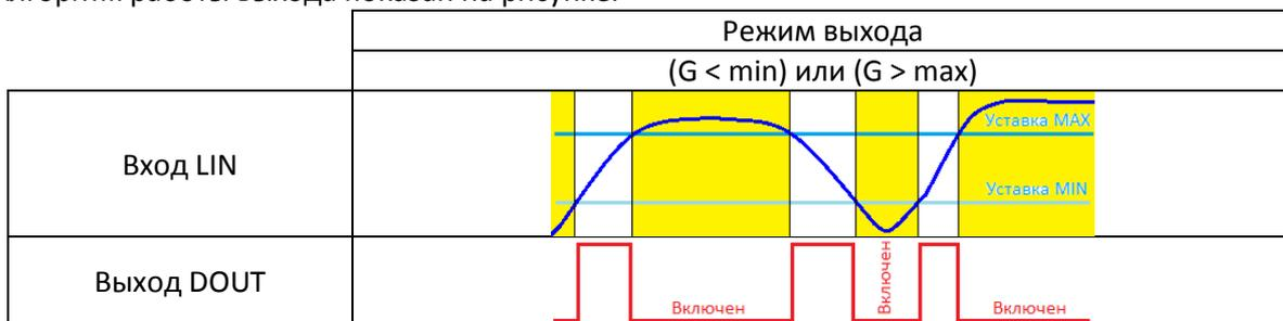
**Примечание** При установке признака «+Отсутствие измерений» в настройках дискретный выход переводится в состояние «Включен» при неисправности, выявленной системой внутренней диагностики расходомера, а также при отсутствии связи с расходомером по каналу LIN.
