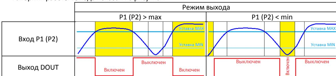
**Примечание** При установке признака «+Отсутствие измерений» в настройках дискретный выход переводится в состояние «Включен» при значении входного тока менее 3,2 мА или более 24 мА.
