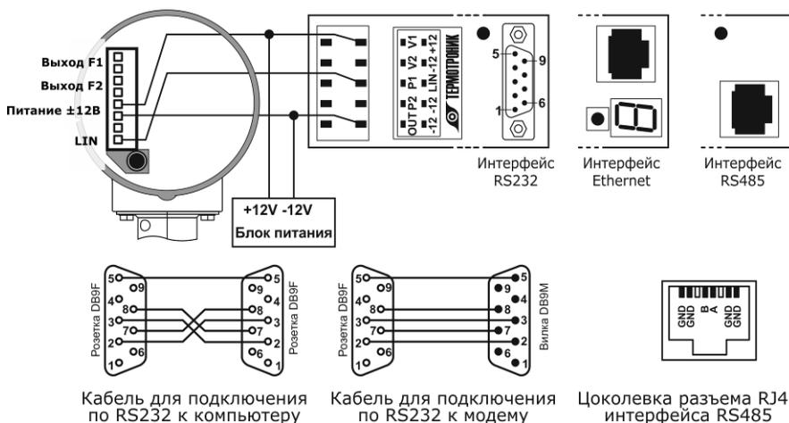
Рис. 7 – Схема подключения адаптеров RS-232, RS485, Ethernet
