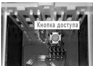
Рис. 10 – Расположение кнопки доступа АДИ -1-0(1)
