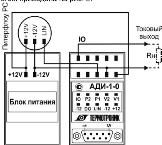
Рис. 9 – Схема подключения АДИ-1-0(1) к расходомеру
