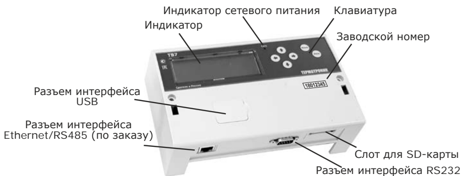
Рис. 2.1 – Внешний вид приборного отсека ТВ7 (вид сверху)
