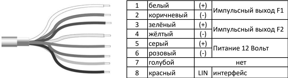
Рис. 3 Схема подключения расходомера с IP68
