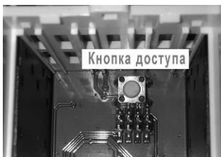
Рис. 11 – Расположение кнопки доступа АДИ -1-0(1)
