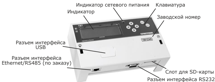
Рис. 2.1 – Внешний вид приборного отсека ТВ7 (вид сверху)
