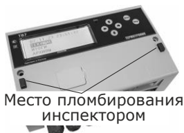
б) Пломба инспектора снабжающей организации
