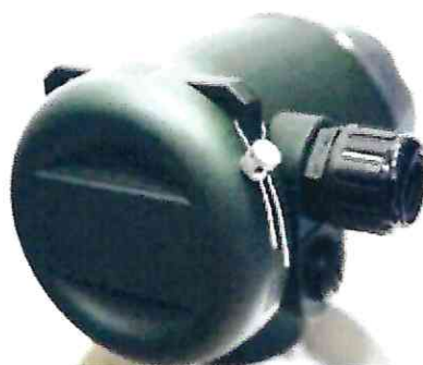
Рисунок 3 – Место пломбировки от несанкционированного доступа эксплуатирующей организацией расходомера-счётчика Питерфлоу Т модификации 1
