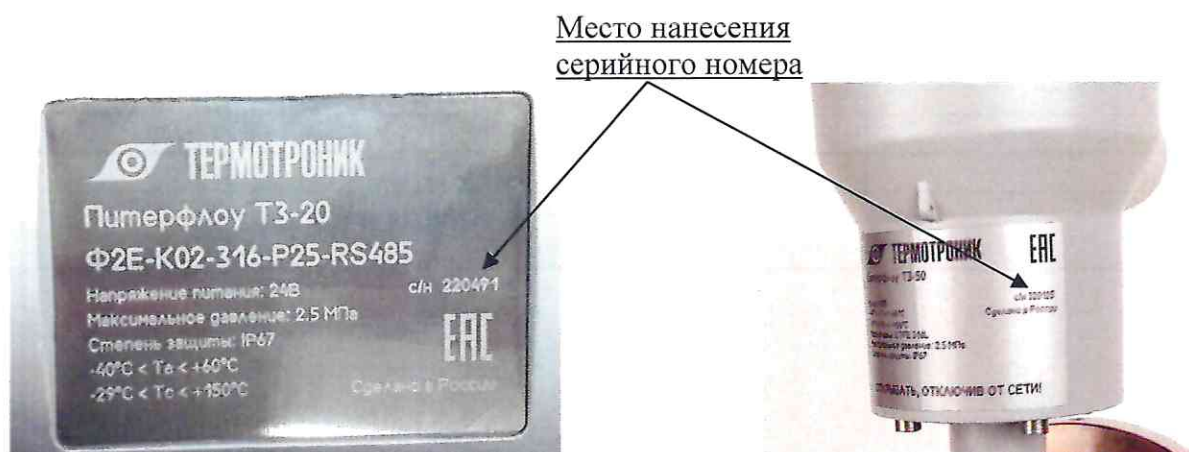
Рисунок 9 – Место нанесения заводского номера на расходомер-счётчик Питерфлоу Т модификации 3
